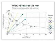
Plattenfeuchte 27 %, kurzfristige Belastung Teilsicherheitsbeiwert des Werkstoffs 1,3, Teilsicherheitsbeiwert der Last 1,2 Durchbiegungskriterium: Spannweite L/300 Auflagefläche ohne Berücksichtigung
